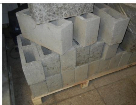
Figura 1: Bloques de construcción elaborados con RSU tratado mediante gasificación térmica. Se observan diferentes tamaños y formulaciones ensayadas.
