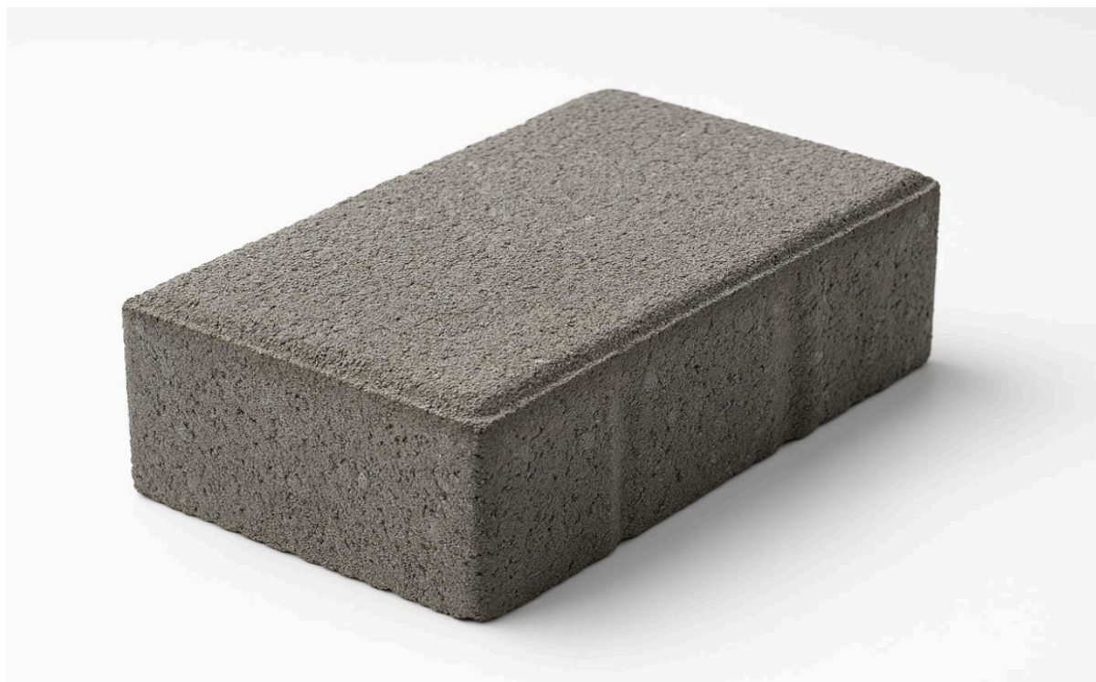
Figura 3: Adoquín de pavimentación elaborado con RSU tratado (20 cm × 10 cm × 6 cm).
